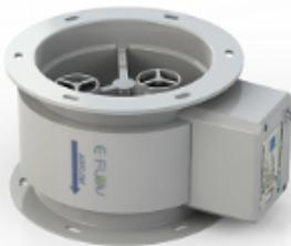
现在大型室内场地需要通风基本都会选择智能风阀，为确保稳定和精确的对风量进行控制，会选择将机械压力无关的调节阀与高速度气流控制器应用在一起，如何正确理解智能风阀压力无关性？有几种处理状态？因为压力无关性，智能风阀在使用中可以自动消除介质压力波动影响，通过阀芯位置的改变来克服压力的波动，以此保持一个恒定的空气流量，通常会需要处理以下两种状态：状态1—管道压力由小变大的过程中，阀芯会随着管道压力而增大，阀芯与阀壁所留的流通面积变小，同时流通的风速在增大，以保持恒定的风量；状态2—管道压力由大变小的过程中，阀芯会随着管道压力变小，阀芯与阀壁所留的流通面积变大，同时流通的风速减小，来保持恒定的风量。
